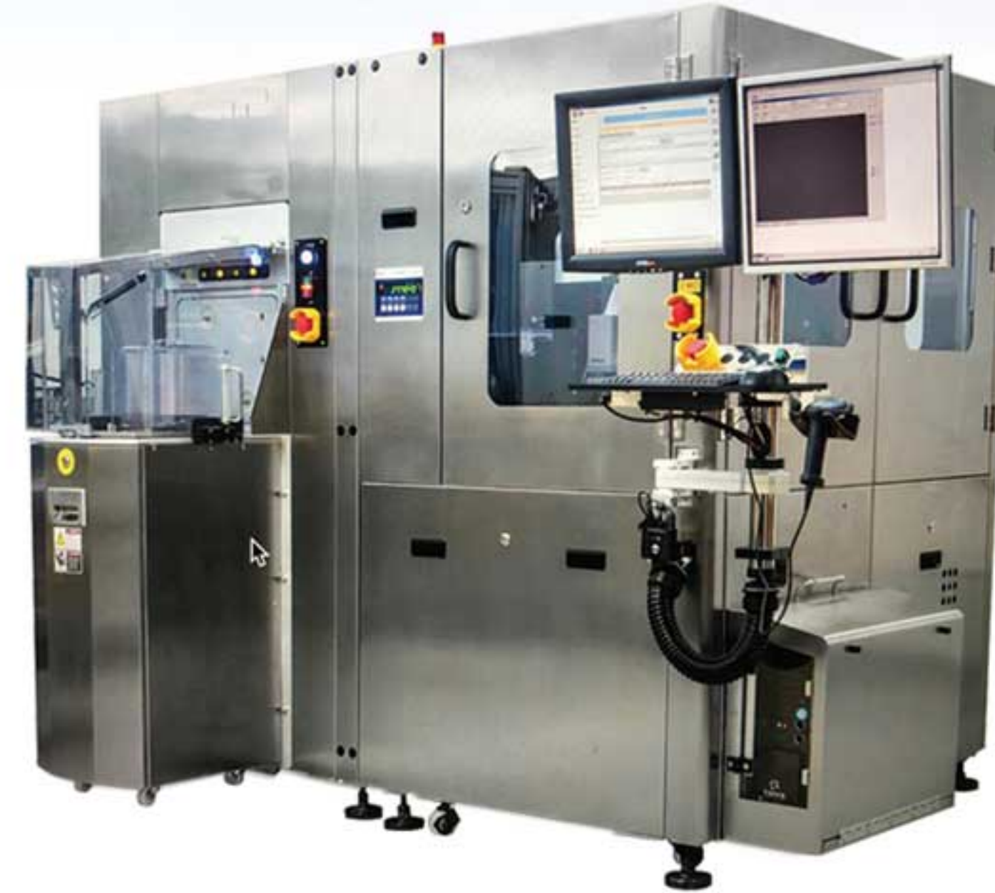
WAFER DIE AOI Die Inspection
